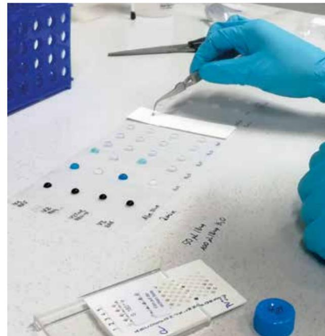
In seinen Forschungen hatte Philipp Vormittag mit winzigen Partikeln zu tun. Um sie sehen zu können, mussten Proben für die Transmissionselektronenmikroskopie vorbereitet werden.
