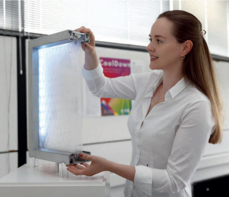
Das schlanke Aluminiumprofil bietet mit einer Ansichtsbreite von nur 35 Millimetern die Kapazitäten zur Aufnahme eines alle 100 Jahre in seiner Intensität auftretenden Schlagregenereignisses. Bewässerungs- und Beleuchtungstechnik sind in das Profil integriert.
