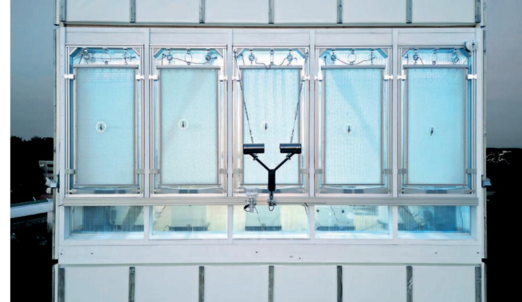
Die Prototypen auf der Westseite des D1244-Hochhauses sind mit umfangreicher Messtechnik ausgestattet, um die Effekte der Regenwasseraufnahme und Verdunstungskühlung genauestens auswerten zu können.
