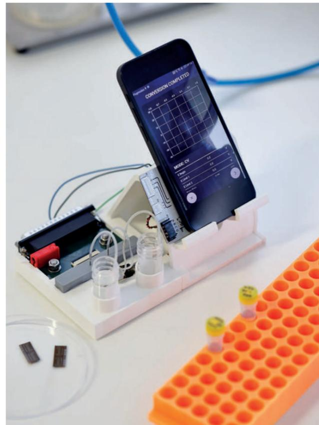
Statt sperriger Laborgeräte: NFC-Potentiostat und Mikroperistaltikpumpe werden vom Smartphone mit Strom versorgt, das die Daten auch direkt auswertet.
