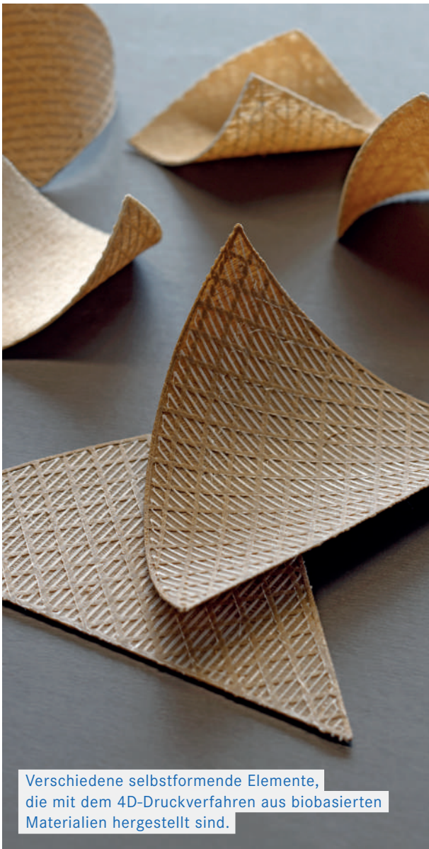
4D-Druckverfahren zur Herstellung der Solar-Gate-Elemente, die zugleich Sensor, Motor und Verschattungselement sind und autonom auf Veränderung des Wetters reagieren können.
