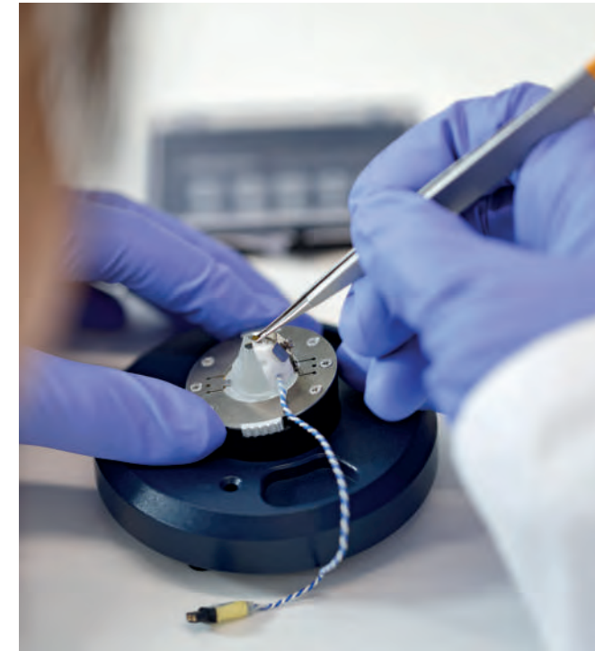
Vorbereitung einer Messung mit einem Rasterkraftmikroskop. So lassen sich selbst kleinste Strukturen im Nanometerbereich sichtbar machen und untersuchen.
