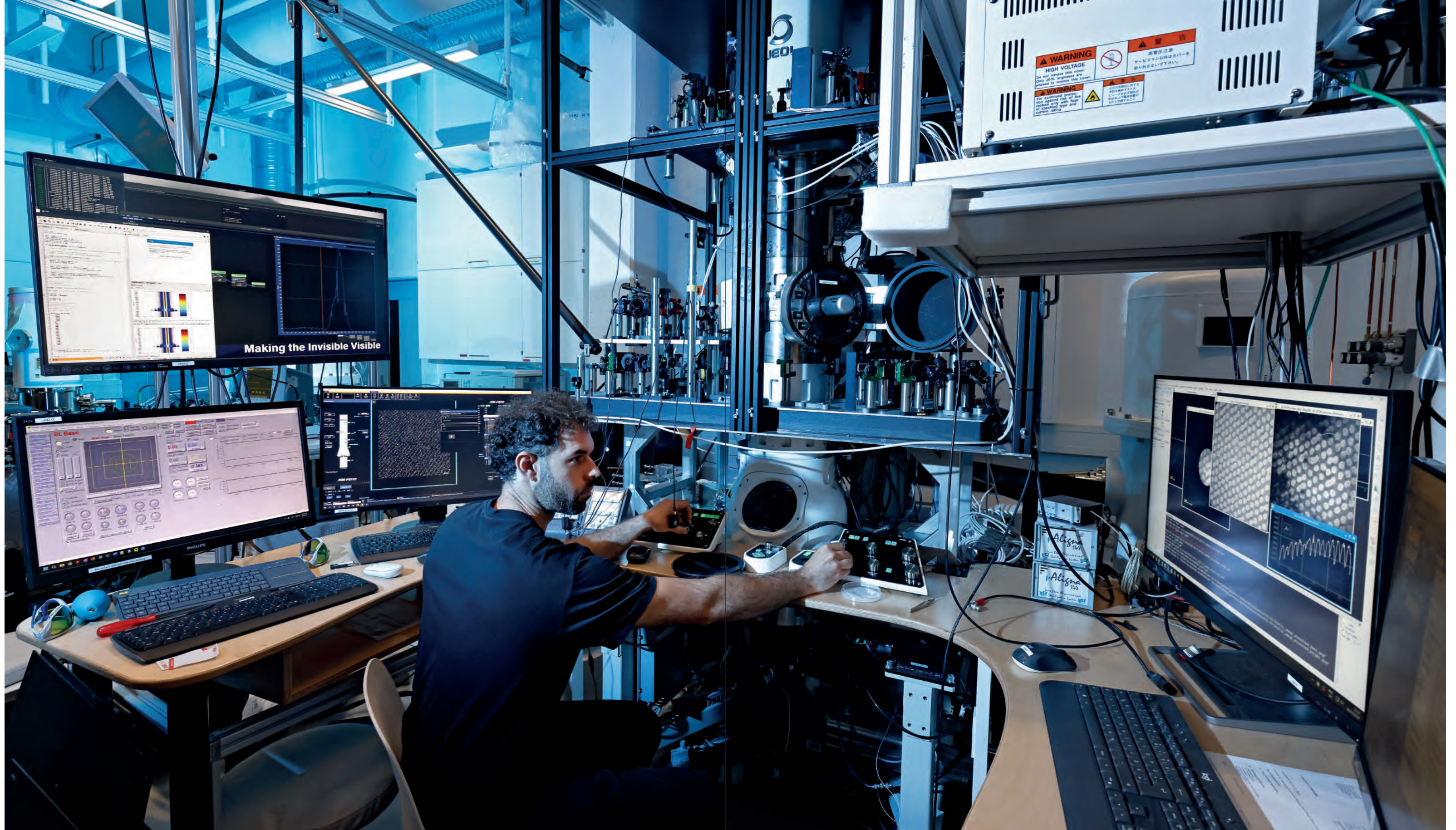
Messaufbau für die Attosekunden-Mikroskopie. Gleichzeitige Kontrolle von Laser- und Elektronenstrahlen erlaubt deren zeitliche und räumliche Überlagerung und damit Präzisionsmessungen von Materialdynamiken. Das Konstanzer Attosekunden-Elektronenmikroskop ist aktuell weltweit einmalig.
