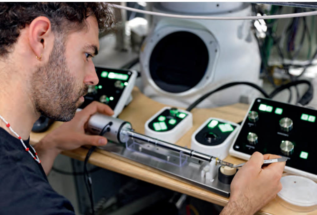
Ein Probenhalter für das ultraschnelle Elektronenmikroskop. Die Dynamik von funktionellen Nanostrukturen und Quantenmaterialien können nun mittels besonderer Attosekunden-Mikroskopie untersucht werden.
